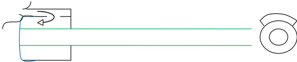
*Un moyen de rendre l'anche de VVZM contrôlable : faire en sorte que la lèvre inférieure puisse toucher la membrane, pour en modifier la tension et l'amortissement.*
