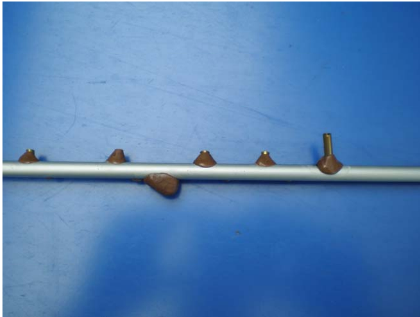
Fig. 18 : Les cheminées latérales sont constituées de petits tubes en cuivre piqués sur le tube principal. Les piquages sont renforcés par du mastic époxy. Sur ce cromorne ténor, la cheminée pour l'auriculaire droit (à droite de la photo) a été faite particulièrement haute pour rendre ce trou de jeu accessible sans pour autant avoir recours à une clé.
