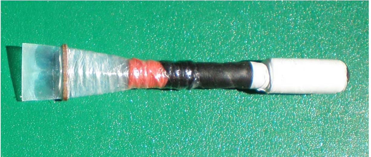
*Une anche en plastique, baguée avec un fil de cuivre épais. On aperçoit sous la bague les renforts des palettes par enroulement de fibre de verre. La bague délimite la zone vibrante de l'anche. Le réglage à la pince de cette bague, ici placée très haut, permet de régler finement l'ouverture et le diapason de l'anche.*
