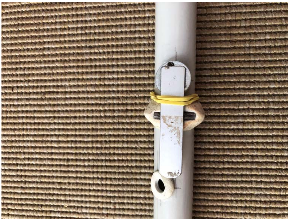
La clé de Mib du traverso PVC : simple, rapide à fabriquer, précis, étanche et sans jeu.
